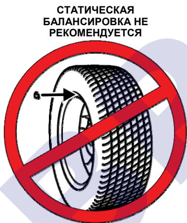
КОРРЕКТИРУЮЩИЙ ВЕС НЕ ПО ЦЕНТРУ КОЛЕСА Рисунок 22.
