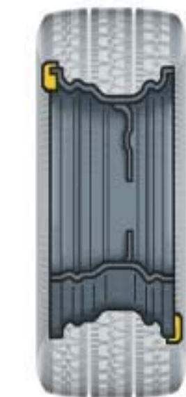
Традиционные стальные диски 1970-х годов с набивными грузами на закраинах обода.
