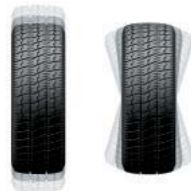
Статический дисбаланс (подпрыгивающее колесо) Парный Дисбаланс (Колблющееся колесо)
