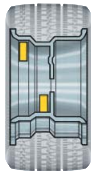
Современные литые легкосплавные диски обычно не имеют закраин обода и требуют большей массы приклеиваемых грузов для коррекции идентичного дисбаланса.
