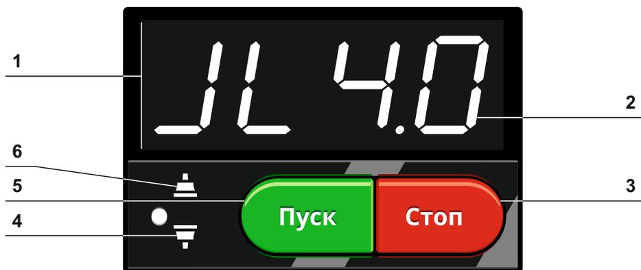
1 – индикатор режимов; 2 – индикатор времени; 3 – кнопка «Стоп»; 4 – сигнализатор нагрева нижнего прижима; 5 – кнопка «Пуск»; 6 – сигнализатор нагрева верхнего прижима.
